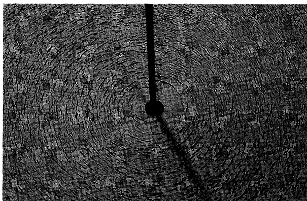
Rys. 30.3. Opiłki żelazne, rozrzucone na kartonie układają się wzdłuż współśrodkowych okręgów, gdy w przewodzie płynie prąd. To ułożenie, wzdłuż linii pola magnetycznego, jest wynikiem działania pola magnetycznego, wytworzonego przez prąd płynący w przewodzie
